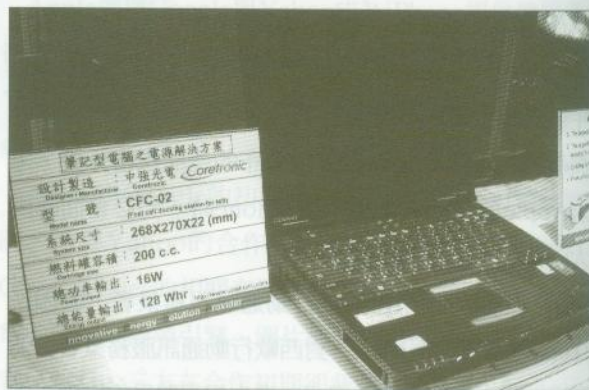
圖1 中強光電所發表的基座型DMFC發電系統原型，可供電給筆記型電腦、可攜式投影機和數位相機。
